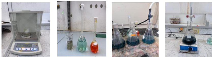
Figure 14: Mesure de la matière organique des différents types de sols (photos prises par Bassirou Maïga le 29 mai 2025)
